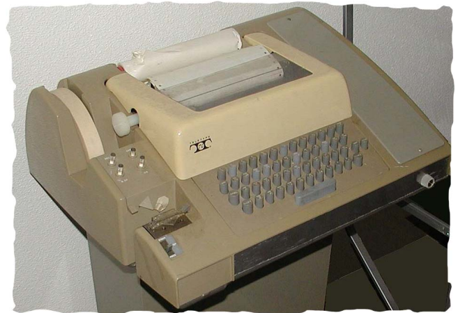
Abbildung 1: Der amerikanischer Fernschreiber namens Teletype ASR-33.
